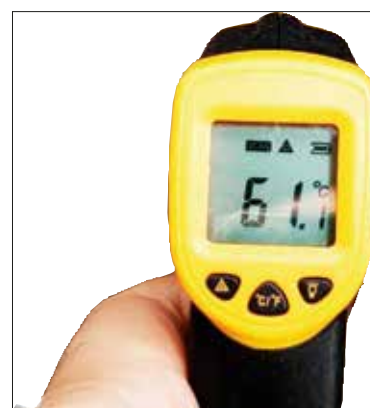
Figura 3 - Medição de temperatura de superfície interna das telhas de fibrocimento com termômetro infravermelho
