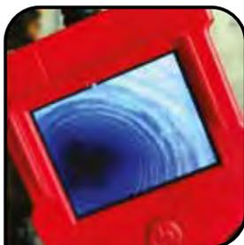
**TUBOSCOPIA:** com o uso de uma micro câmera de alta definição é possível inspecionar em tempo real a condição da tubulação bem como definir o grau de impurezas depositadas na superfície.
