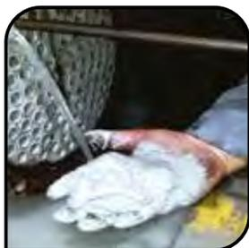
**LIMPEZA TÉCNICA** com máquina e ferramenta exclusiva para retirada de calcário e outras impurezas (sem o uso de produtos químicos) devolvendo a troca térmica do equipamento.
