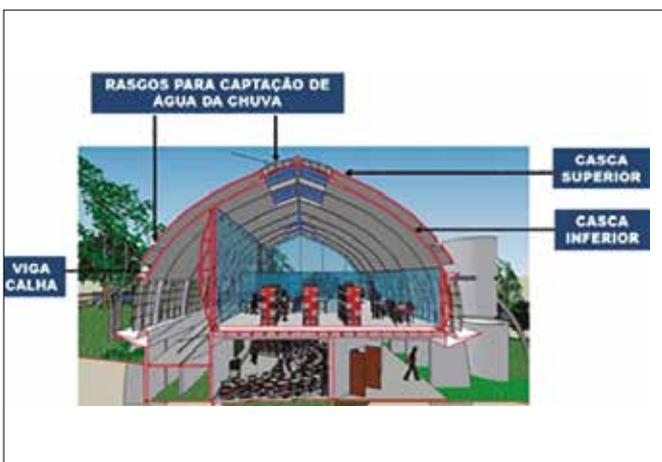
Figura 4 – Corte esquemático do projeto do prédio mostrando a casca dupla e o sistema de captação e água de chuva entre elas (Fonte: Acervo do SEBRAE-MT)
